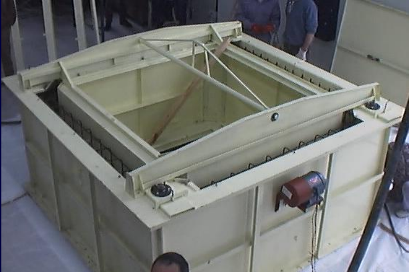
Molde del contenedor armado
